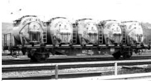
Abb.21: Zweiachsiger Flachwagen mit fünf PA-Behältern für Flüssigkeiten. Markant war die Aufschrift „Von Haus zu Haus“, mit der die DB passende Eigenwerbung betrieb. (PA = porteur aménager = anpassbarer Träger)
