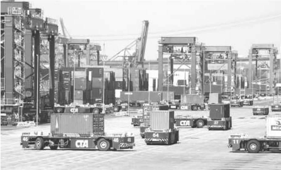
Abb.28: Blick in den Hamburger Hafen, wo eine Vielzahl von AGVs (= Automated Guided Vehicles) „wie von Geisterhand“ Container zwischen den verschiedenen Lagerplätzen hin und her fahren.
