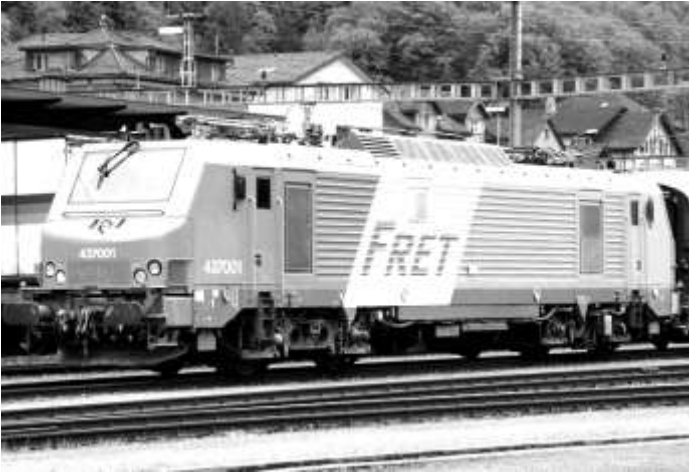
Abb. 17: Nicht nur Siemens baut Mehrsystemloks wie den „Euro-Sprinter“. Die französische Staatsbahn SNCF setzt zum Beispiel im Güterverkehr auf die Baureihe 437 von Alstom.
