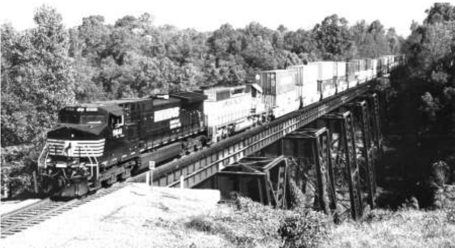
Abb.30: In Nordamerika gehören kilometerlange Züge, die von mehreren Lokomotiven gezogen werden, zum Alltagsbild. Durch doppelstöckige Containerbeladung können die Weistreckentransporte noch effizienter durchgeführt werden.
