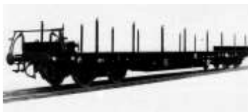
Abb.3: Flachwagen der Baureihe R. Speziell für den Containertransport gebaute Wagen haben zur Gewichtsersparnis auch keine Rungen mehr.
