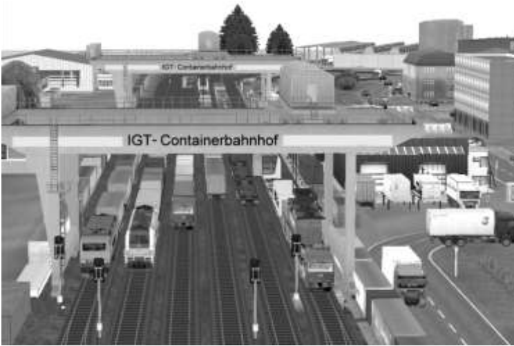
Abb.42: Im virtuellen Containerbahnhof ist auf Gleis 5 ein CEC angekommen. Sofort fangen die Kräne an die Behälter abzuladen, die für die CIR auf den Gleisen 1 und 4 oder für Betriebe in der Umgebung bestimmt sind.
