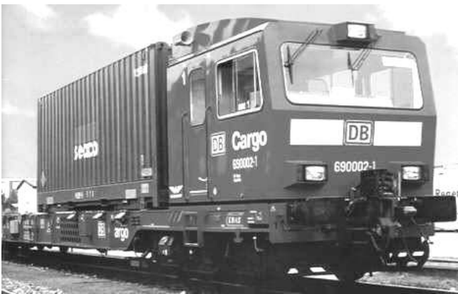
Abb.33: Kopfwagen des Cargo-Sprinters (Baureihe 690 der DB).
