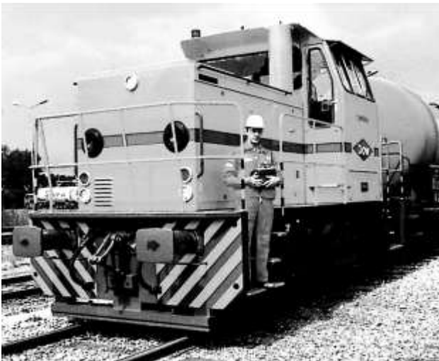
Abb.35a: Rangierleiter mit „Bauchladen“ zur Fernsteuerung der Lokomotive.
