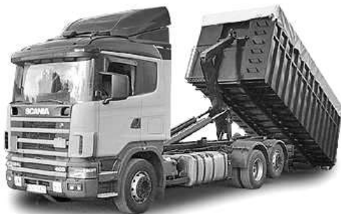
Abb.40: Abrollcontainer haben Rollen an ihrem genormten Unterrahmen. Die LKWs für den Straßentransport besitzen Ketten- oder Hakengeräte, mit denen sie die Behälter an jedem geeigneten Platz auf- und abladen können. Abrollcontainer gehören z.B. vielerorts an Müllsammelstellen für Altglas, Altpapier, Bauschutt und Industrieabfälle zum gewohnten Stadtbild.
