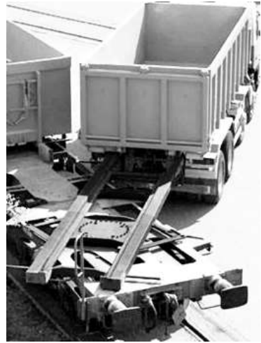
Abb.41a: Flachwagen mit ausgeschwenktem Drehrahmen. Der Abrollcontainer wurde gerade vom LKW herunter gezogen.
