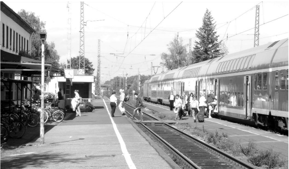
Abb.48: Zwischen Bamberg und Nürnberg gibt es immer noch vier Bahnhöfe ohne Bahnsteigunterführung. So wie in Hirschaid müssen die Fahrgäste beim Ein- und Aussteigen über das Gleis der Gegenrichtung laufen. Natürlich darf in dieser Zeit kein Zug nach Nürnberg fahren, was bei der Fahrplangestaltung beachtet werden muss und bei Verspätungen dennoch dazu führt, dass ICEs und Güterzüge vor dem Halt zeigenden Einfahrtsignal warten müssen.
