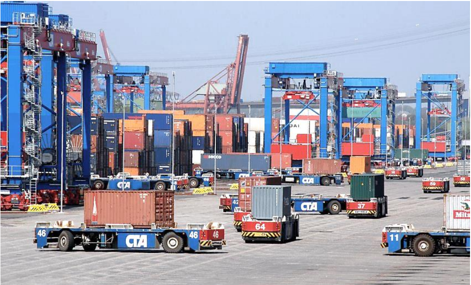
Abb.28: Blick in den Hamburger Hafen, wo eine Vielzahl von AGVs (= Automated Guided Vehicels) „wie von Geisterhand“ Container zwischen den verschiedenen Lagerplätzen hin und her fahren.
