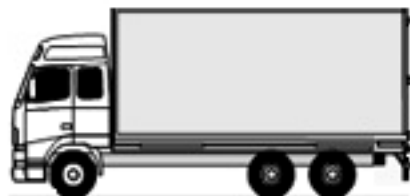
Abb.23: Wesentliche Längen von Wechselhaltern. Oben ein A-Behälter mit einem Gesamtgewicht bis zu 34 t, unten ein C-Behälter mit einem Gesamtgewicht bis zu 16 t. Beide können bis zu 2,60 m breit und 2,90 m hoch gebaut werden.
