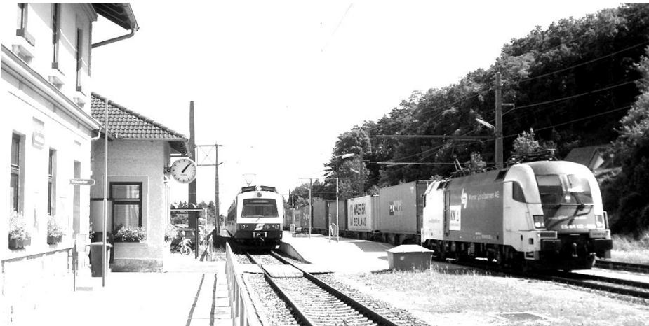
Abb.11: Ein Containerzug der Wiener Lokalbahn AG kreuzt am 20.8.06 auf dem Weg nach St.Pölten in Traismauer einen Personenzug nach Wien. Die Container werden von der Siemens-Lok ES 64 U2 - 20 gezogen, die zur 2. Generation der erfolgreichen „Euro-Sprinter-Familie“ gehört.
