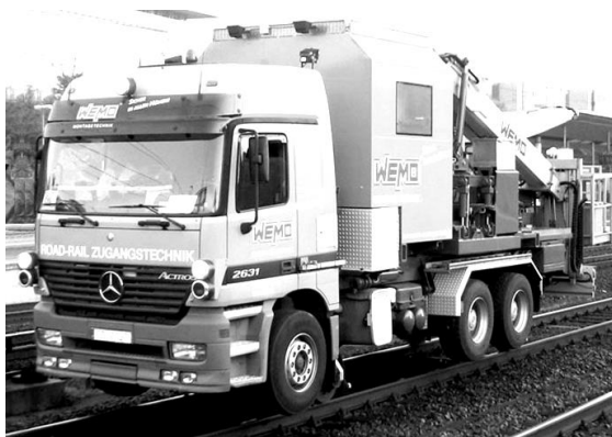
Abb.39: „Schiener-LKWs“ dienen heutzutage meistens der Sicherheit, z.B. bei der Feuerwehr und der Tunnelinspektion. Statt der festen Geräteaufbauten kann auf der Ladefläche natürlich auch eine Tragplatte für Container befestigt werden.
